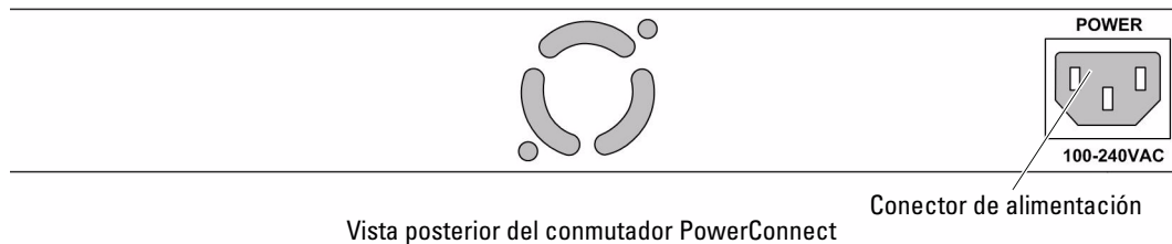
Figura 1-4. Conectores de alimentación del panel posterior
